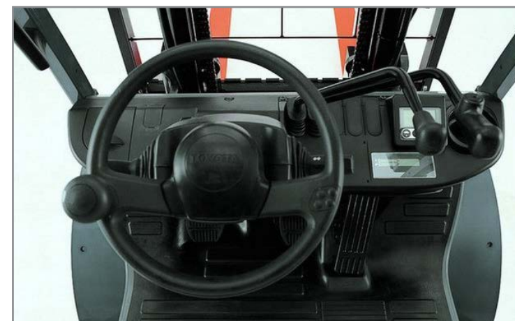
Эргономичное рулевое управление с гидросилителем
